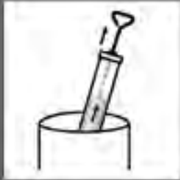
Remplissage par aspiration
