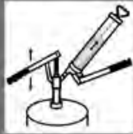
Remplissage par distributeur de graisse vrac
