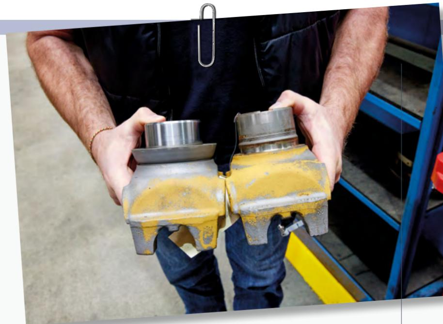
Tulipes de chargeuse à pneus 972 M XE, rénovée à gauche avec métallisation puis usinage.
